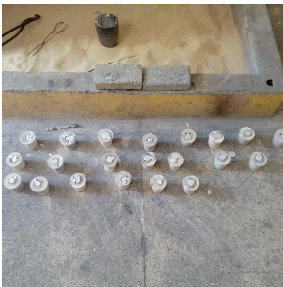
Figura 11 – Cascas cerâmicas com metal líquido vazado
