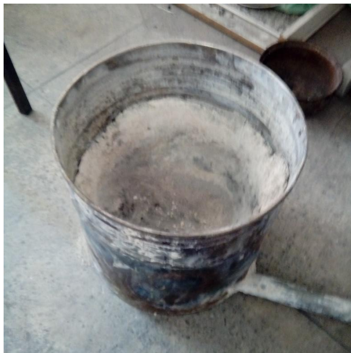
Figura 8 – Forno a cadinho removível utilizado na fundição
