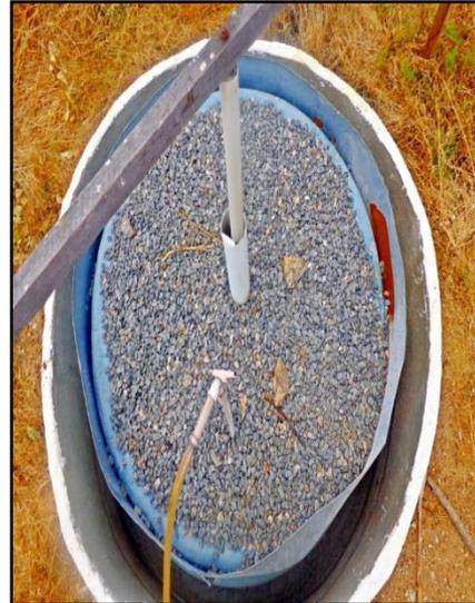
Fonte: BRITO, C, S.2016. Equipamento que possibilitam o reaproveitamento de detritos para gerar gás metano. O biodigestor geralmente é alimentado com restos de alimentos e fezes de animais, acrescidos de água.
