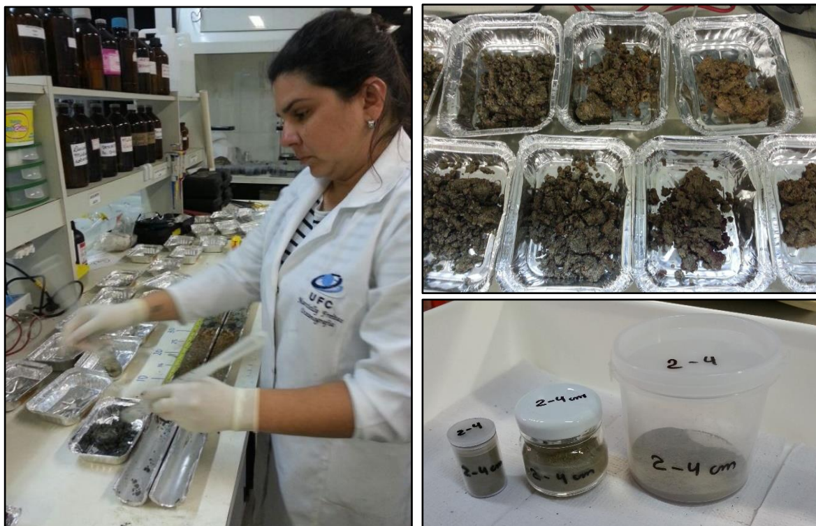
Figura 9: Separação das frações a cada 2 cm (esquerda), armazenamento em recipientes de alumínio para congelamento e posterior liofilização (direita superior) e alíquotas de cada fração separadas para determinação dos diferentes analitos de interesse (Fonte: O autor).
