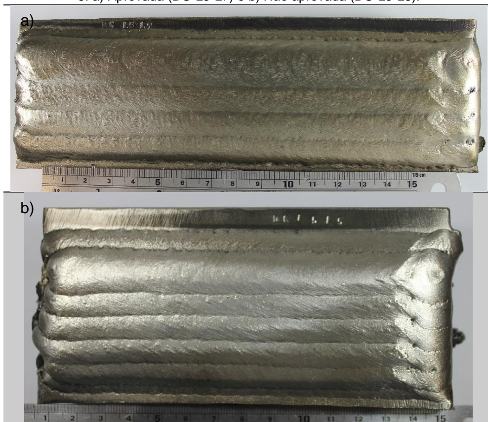
Figura 126 – Dupla camada soldada em metal de base de ASTM A387 Gr11 - AWS ERNiCrMo-3. a) Aprovada (DC-L5-L7) e b) Não aprovada (DC-L5-L5).
