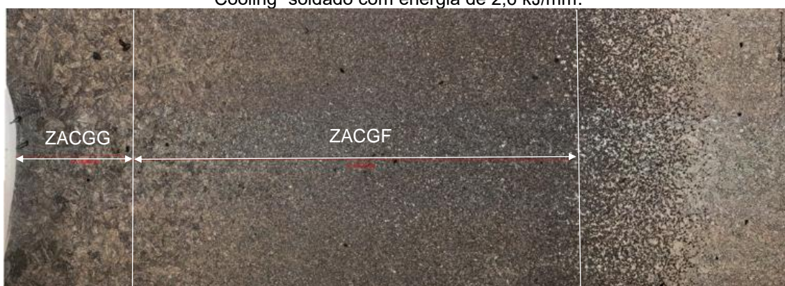
Figura 144 - Montagem da ZAC do aço ASTM A182 F22 normalizado e revenido com "Step Cooling" soldado com energia de 2,6 kJ/mm.
