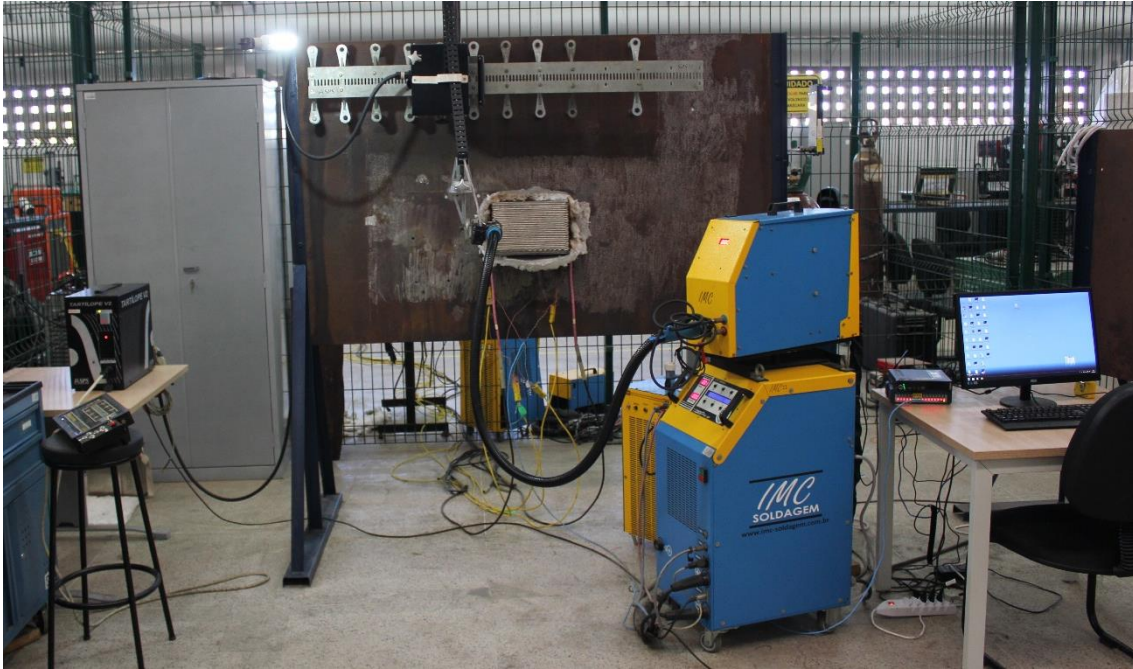
Figura 162 - Reparo de revestimento – Corpo de prova soldado.
