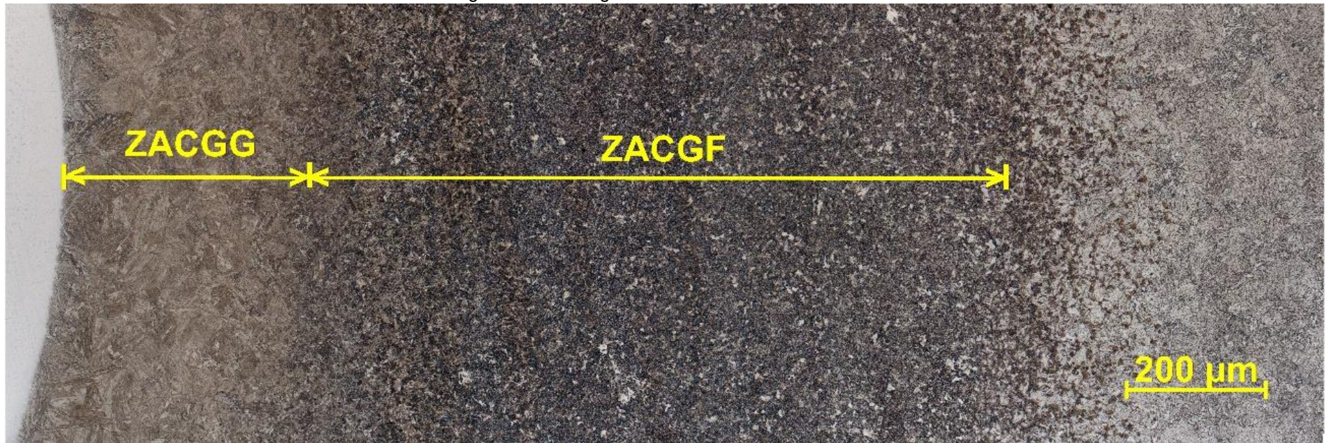
Figura 32 - Montagem da microestrutura da ZAC.
