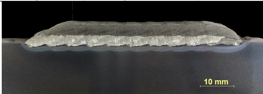
Figura 125 – Aspecto da seção transversal da dupla camada.
