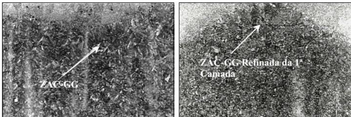
Figura 11 - Microestrutura da ZAC-GG: (a) cordão isolado (b) corpo de prova com dupla camada.
