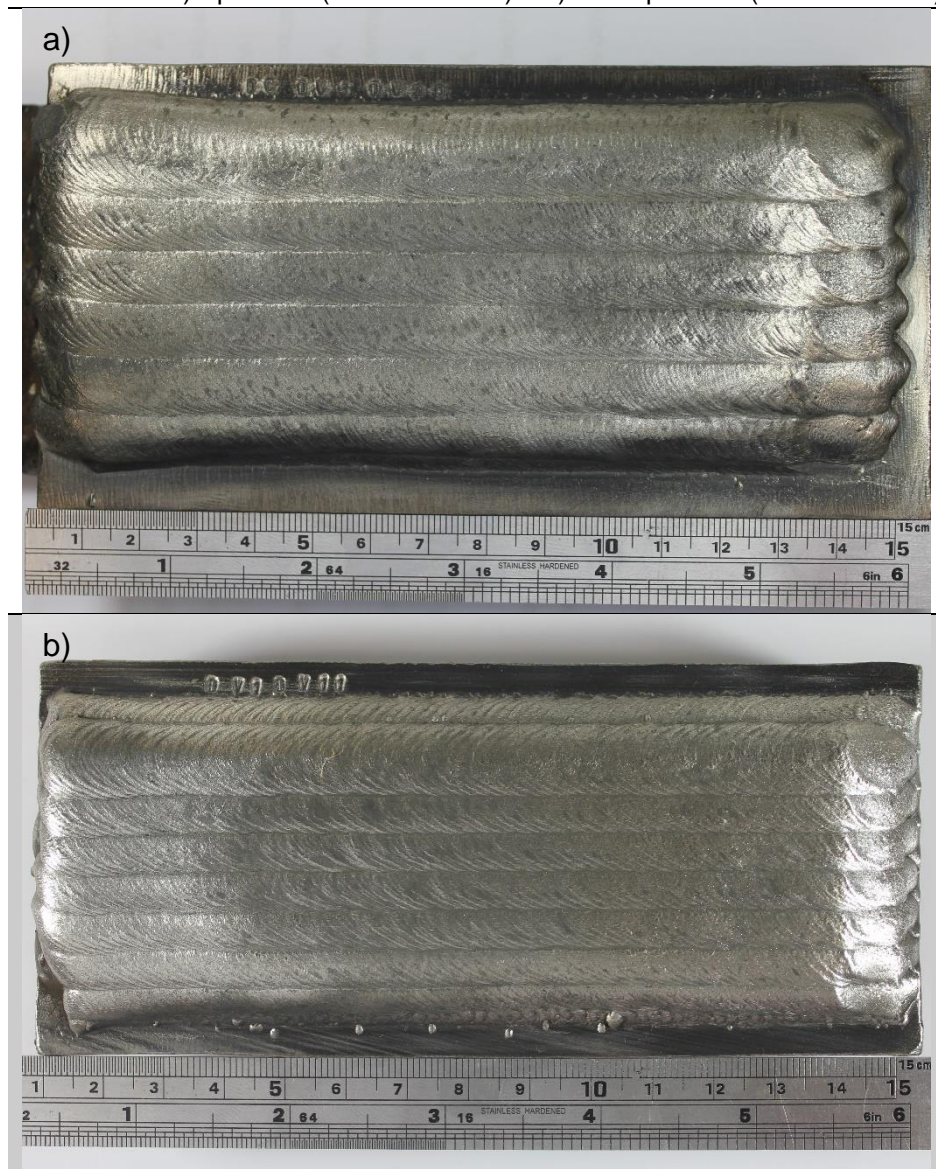
Figura 128 – Dupla camada soldada em metal de base ASTM A542 Tipo D - AWS ER309L e AWS ER347. a) Aprovada (DC-DV6-DV20) e b) Não aprovada (DC-DV1-DV11).
