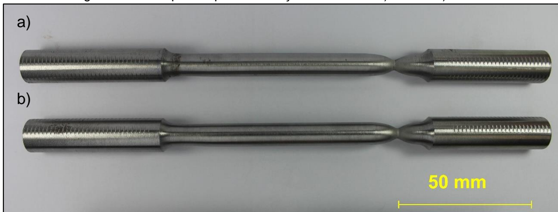
Figura 176 – Corpos de prova de tração ensaiados. a) R2-3 e b) R2-15.
