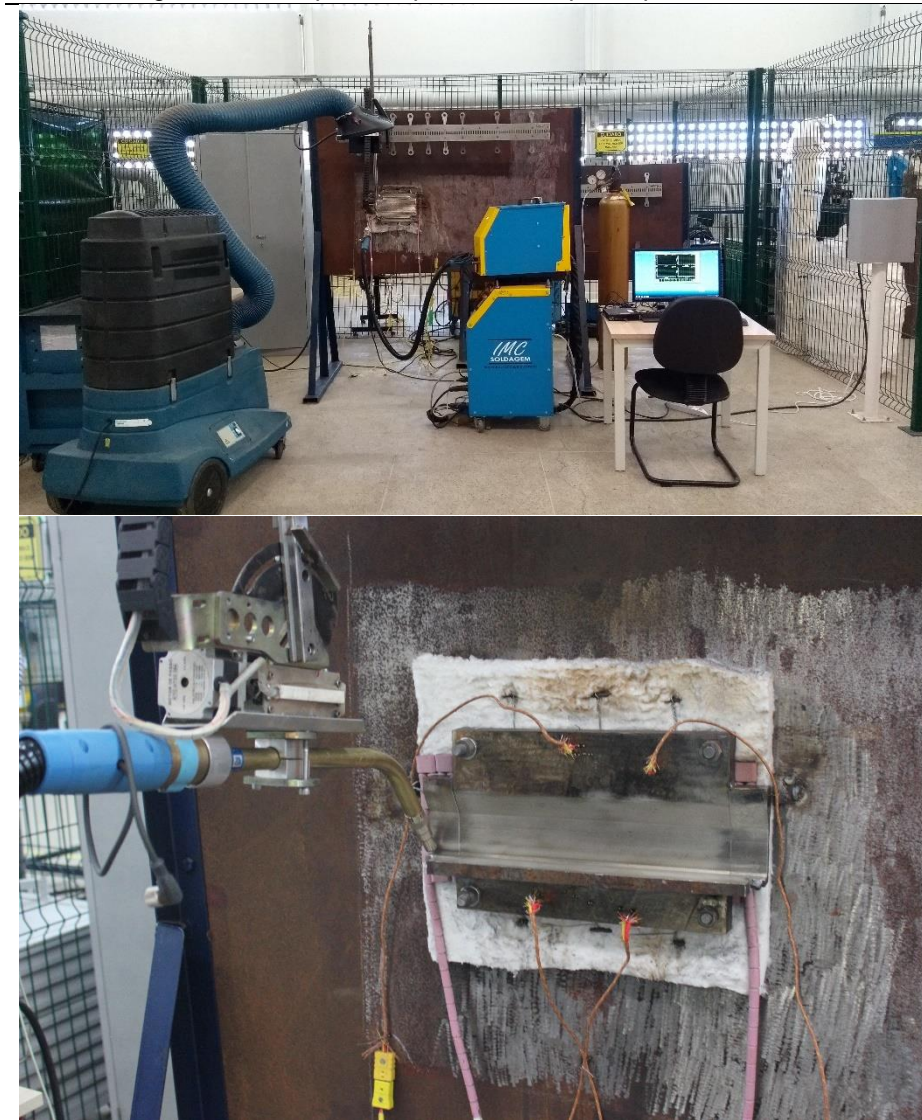
Figura 160 - Reparo de parede – Corpo de prova soldado.
