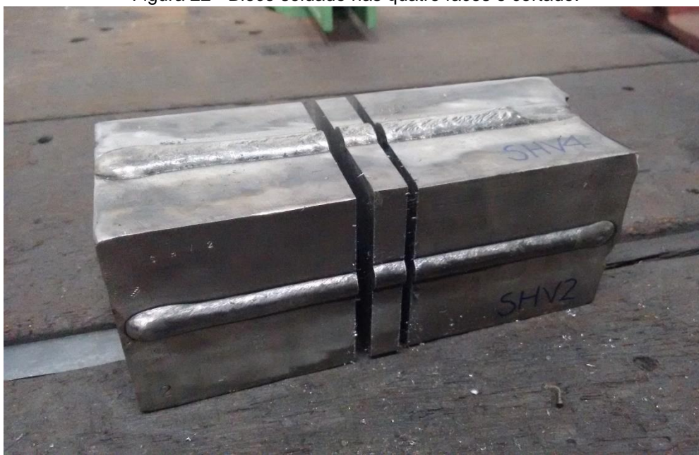
Figura 22 - Bloco soldado nas quatro faces e cortado.
