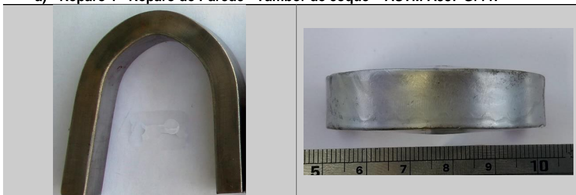
Figura 174 - Corpos de prova após dobramentos reparos em Tambor de coque e reator HDT.
