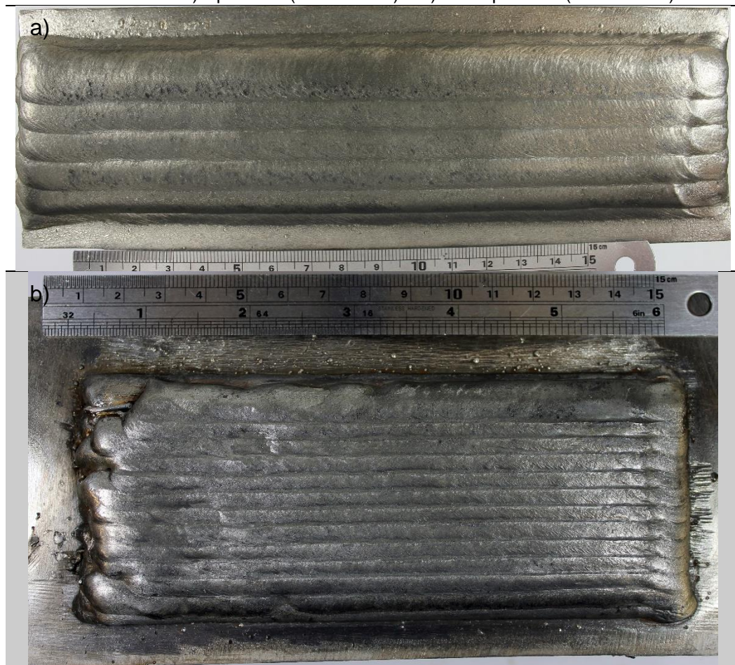
Figura 127 – Dupla camada soldada em metal de base ASTM A387 Gr22 - AWS ER309L e AWS ER347. a) Aprovada (DC-D6-D18) e b) Não aprovada (DC-D1-D11).
