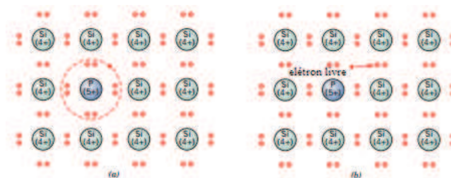
Figura 4.4 - Modelo de semicondução extrínseca do tipo-n: (a) dopagem do silício com átomo de fósforo, (b) elétron livre se movimentando em resposta ao campo elétrico
