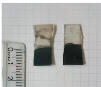
Figura 5.4 – Filmes de CdTe obtidos por eletrodeposição pulsada
