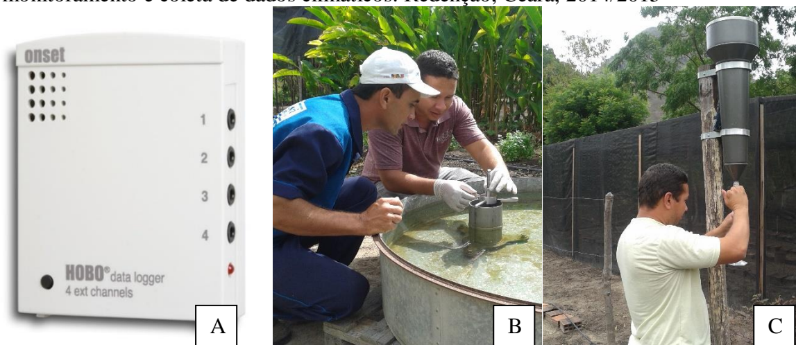
Figura 2 – Datalogger HOBO® (A), Tanque Classe “A” (B) e Pluviômetro (C) para monitoramento e coleta de dados climáticos. Redenção, Ceará, 2014/2015
