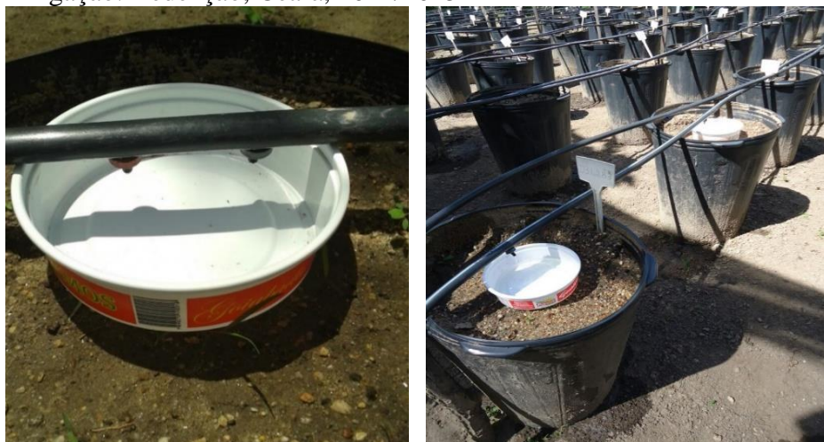
Figura 10 - Coleta do volume de água para avaliação do sistema de irrigação. Redenção, Ceará, 2014/2015
