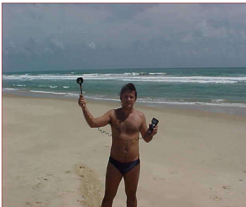
Figura 15 – Medição da velocidade e direção do vento com anemômetro.
