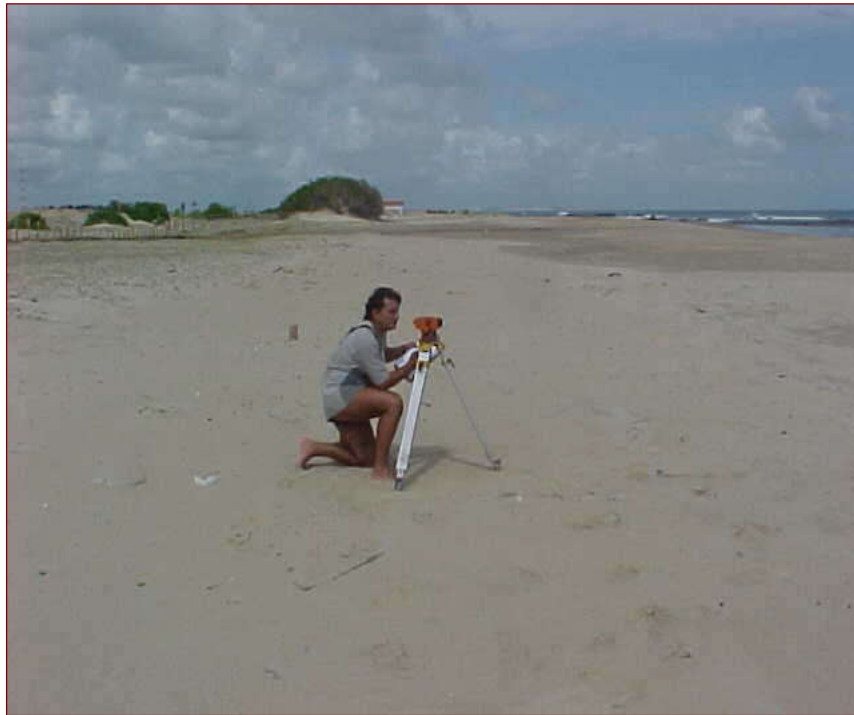
Figura 18 – Perfil Topográfico transversais a linha de costa.
