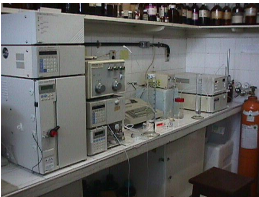
Figura 10 - Aparelho de HPLC com detecção de fluorescência e eletroquímica – Departamento de fisiologia e farmacologia – Universidade Federal do Ceará.
