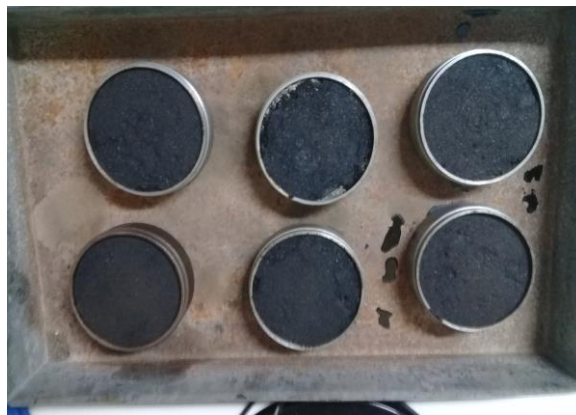
Figura 30 – Corpo de prova do material de base após receber a imprimação
