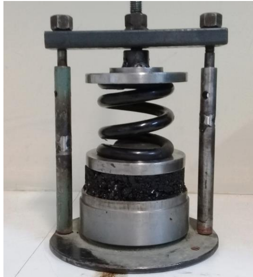
Figura 27 – Sistema de aplicação de carga axial - Protótipo
