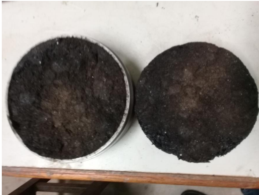
Figura 54 – Face superior da base granular imprimada (esquerda) e revestimento asfáltico (direita) após a ruptura
