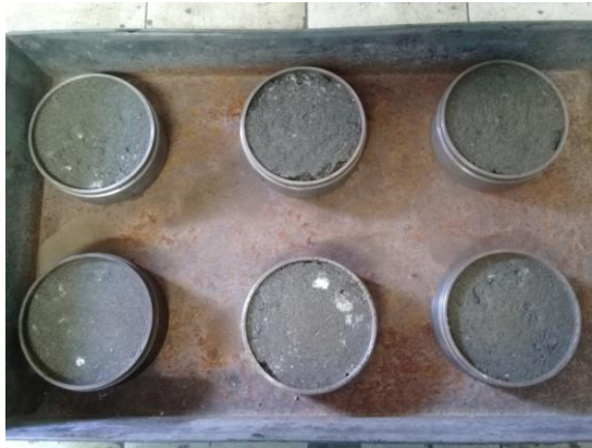
Figura 29 – Corpo de prova do material de base antes de receber a imprimação
