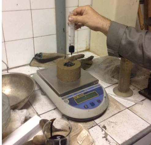
Figura 4 – Aplicação da imprimação
