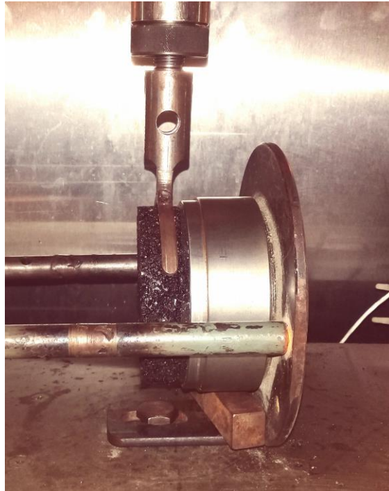
Figura 28 – Aplicação da carga em interface sem tensões axiais - Protótipo
