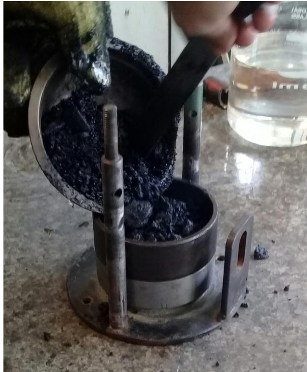
Figura 31 – Aplicação da massa asfáltica sobre a base
