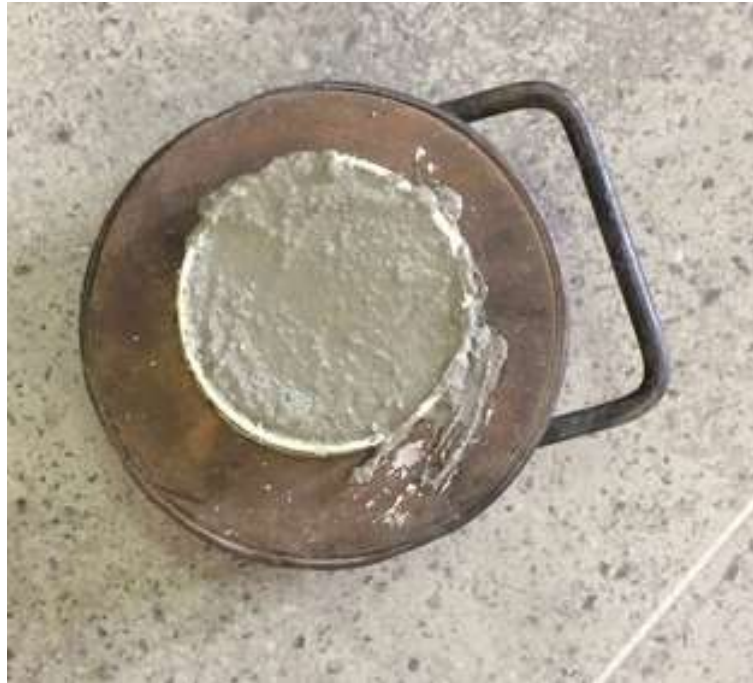
Figura 24 - Moldagem dos corpos de prova para o ensaio de Squeeze-flow (vista superior)
