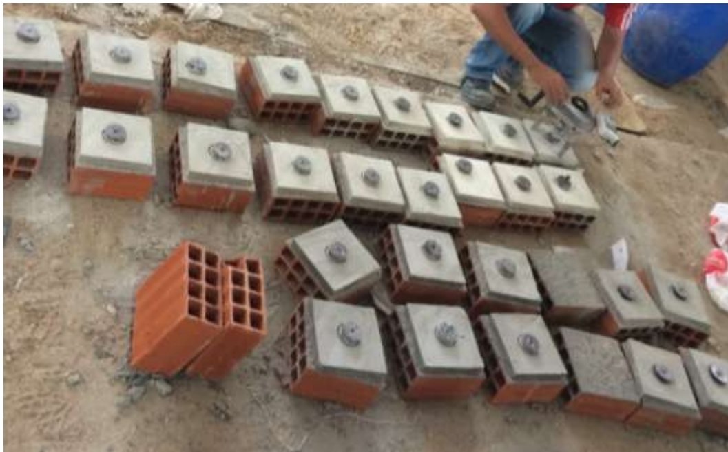
Figura 34 - Ensaio de resistência de aderência à tração em blocos cerâmicos
