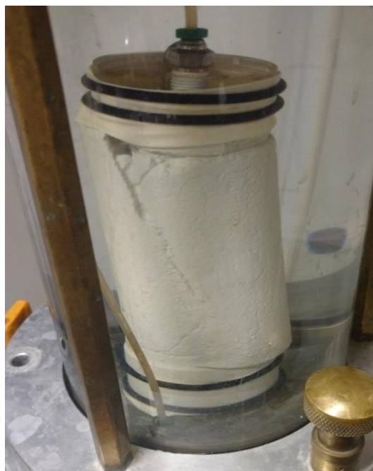
Figura 3.15 – Aspecto geral dos corpos-de-prova após a ruptura (c).
