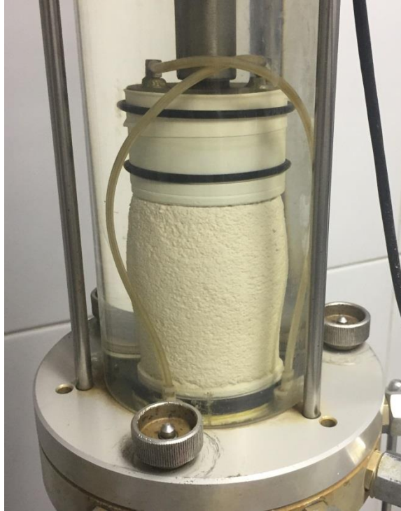
Figura 3.16 – Aspecto geral dos corpos-de-prova após a ruptura (d).
