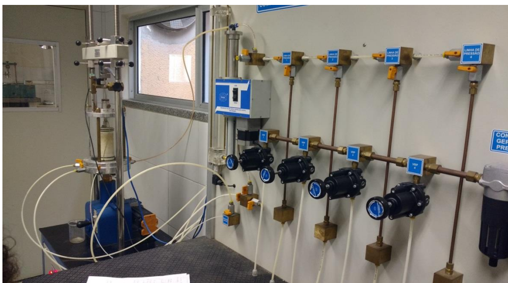
Figura 3.6 – Painel e Célula de pressão para ensaios triaxiais.
