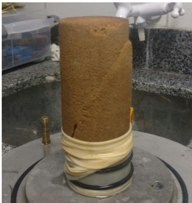
Figura 3.14 – Aspecto geral dos corpos-de-prova após a ruptura (b).
