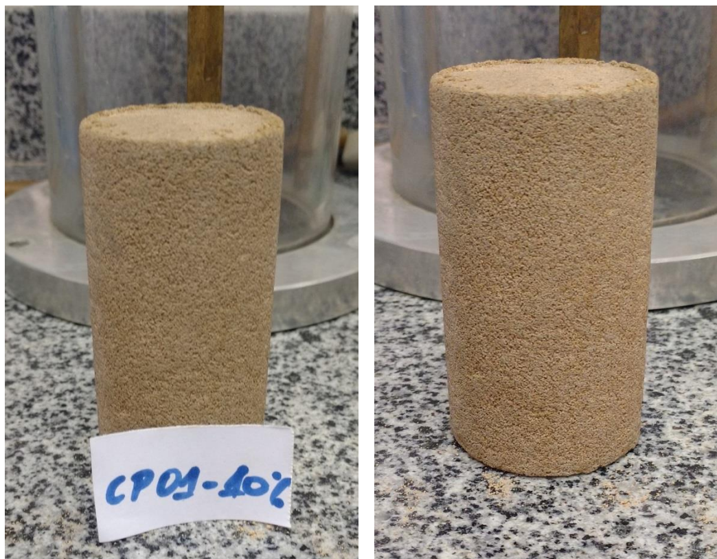
Figura 3.5 – Corpos de prova moldados (Teor de 10 %).
