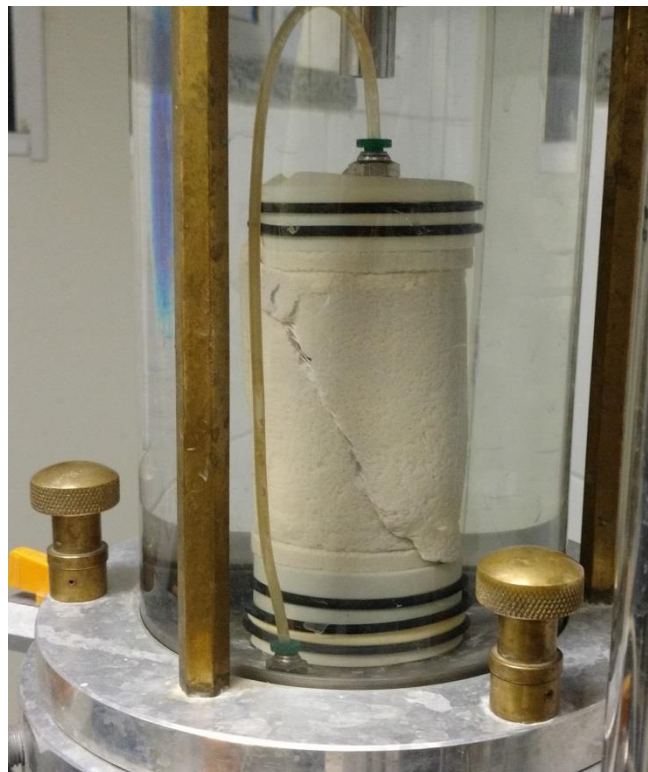
Figura 3.13 – Aspecto geral dos corpos-de-prova após a ruptura (a).
