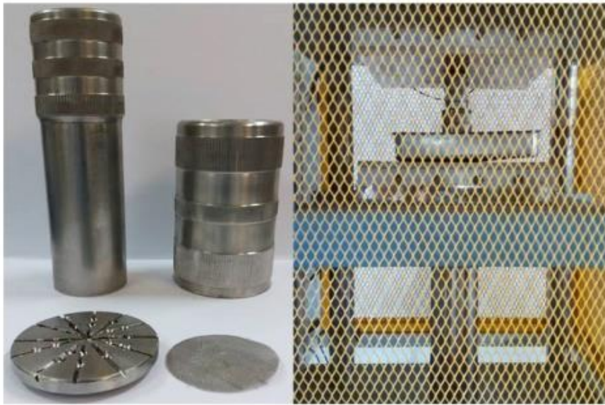
Figura 5 - Célula de extração de óleo e prensa hidráulica.
