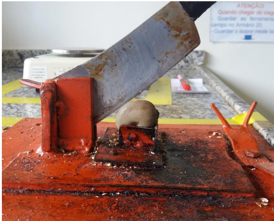
Figura 4 - Faca de corte longitudinal com suporte para castanha, para separação entre cascas e amêndoas.
