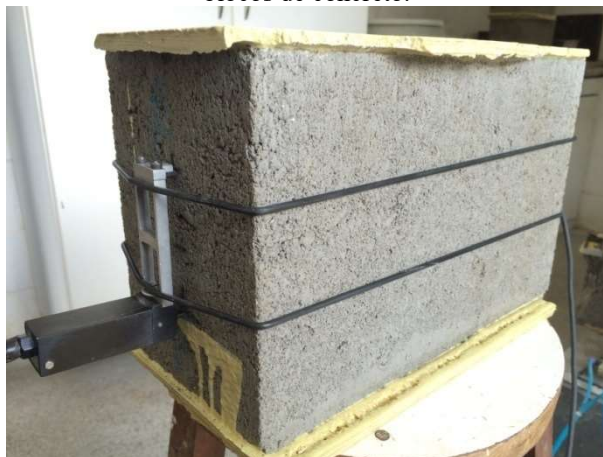
Figura 12 – Fixação do equipamento utilizado na pesquisa para determinação do módulo de deformação dos blocos de concreto.
