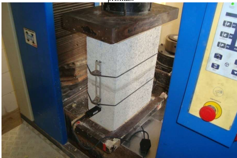
Figura 14 – Fixação do equipamento utilizado na pesquisa para determinação do módulo de deformação dos prismas.
