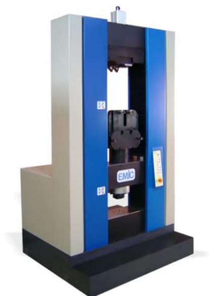
Figura 10 – Equipamento utilizados nos ensaios de resistência a compressão dos blocos de concreto utilizados na pesquisa.
