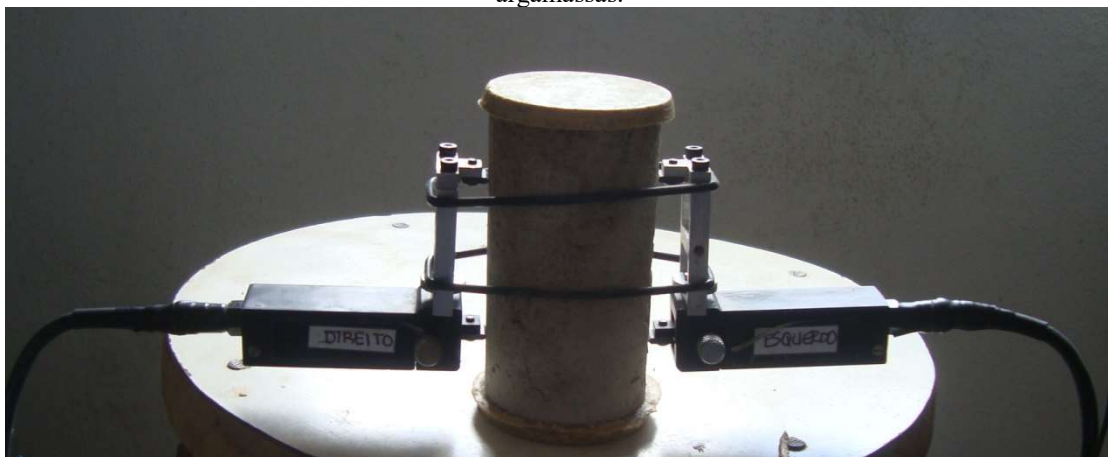
Figura 13 – Fixação do equipamento utilizado na pesquisa para determinação do módulo de deformação das argamassas.
