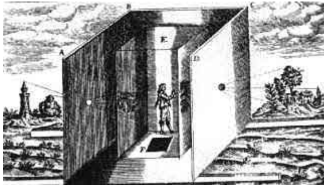
Figura 31— Ilustração da Grande Câmara Escura em forma de liteira, feita em 1646 por Athanasius Kircher.
