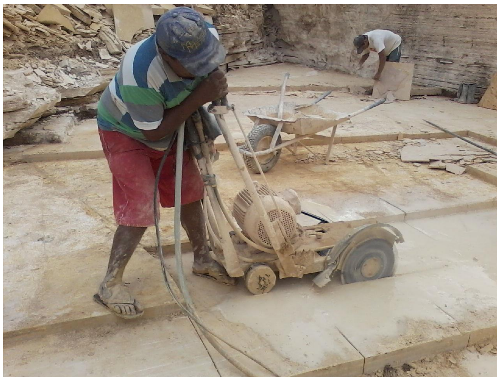
Figura 7 - Utilização do policorte para o corte dos blocos calcários.
