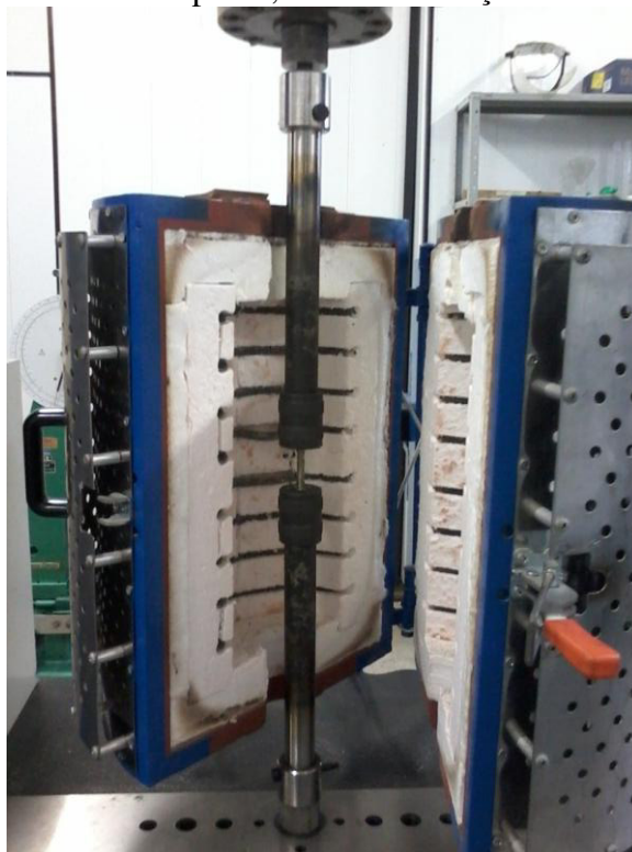
Figura 14 - Forno acoplado, hastes de fixação e um CP fixado.
