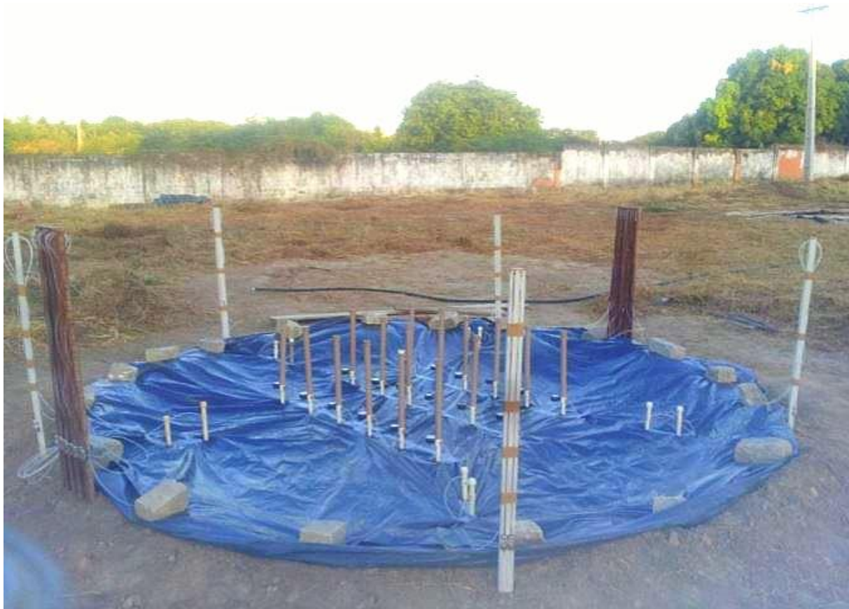
Figura 1 - Cenário do experimento tipo perfil instantâneo no Argissolo Amarelo.
