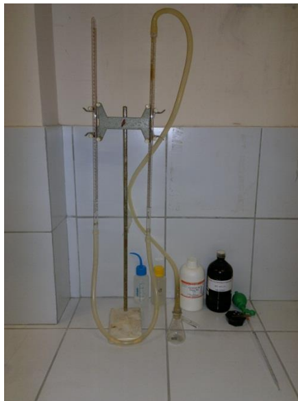
Figura 13 – Calcímetro de Bernard modificado (Fonte: autor).
