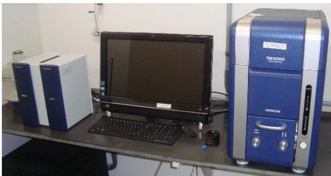
Figura 16 – Microscópio Eletrônico de Varredura (da marca HITACHI) similar ao utilizado na Universidade Federal do Ceará com Espectrômetro de Energia Dispersiva (da marca Oxford) acoplado ao mesmo (situado à esquerda do monitor da imagem) (Fonte: Grupo de Eletroquímica e Química Ambiental da Universidade Federal dos Vales do Jequitinhonha e Mucuri – UFVJM).
