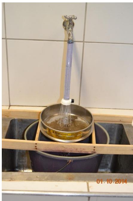
Figura 8 – Etapa do peneiramento úmido (Fonte: autor).
