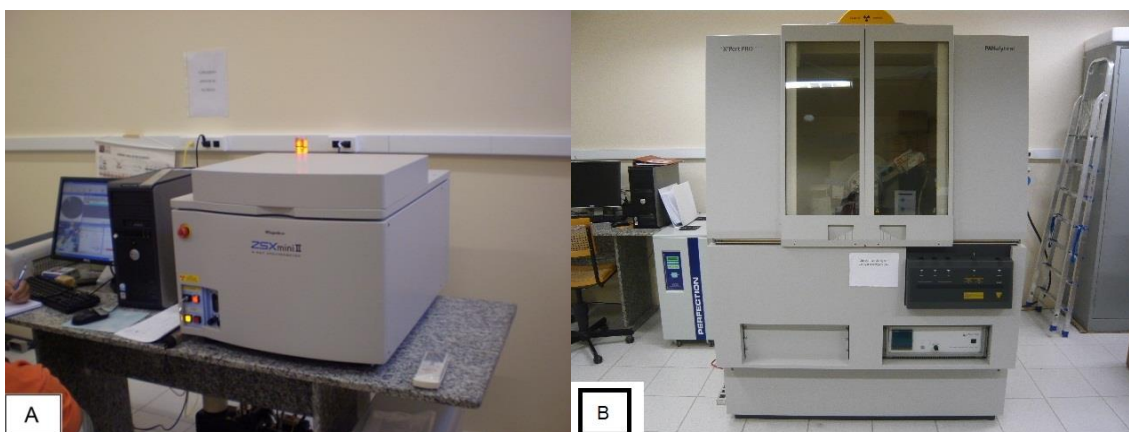
Figura 15 – A) Equipamento utilizado na fluorescência de Raios-X. B) Difratorômetro de Raios-X. (Fonte: Laboratório de Raios-X – UFC).
