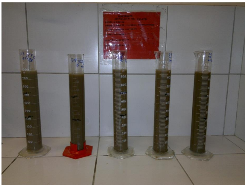
Figura 11 – Amostras no início da etapa de pipetagem (Fonte: autor).
