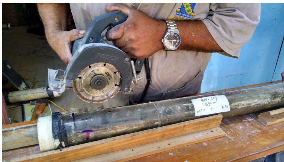
Figura 7 – Etapa de serragem do tubo de PVC (Fonte: autor).
