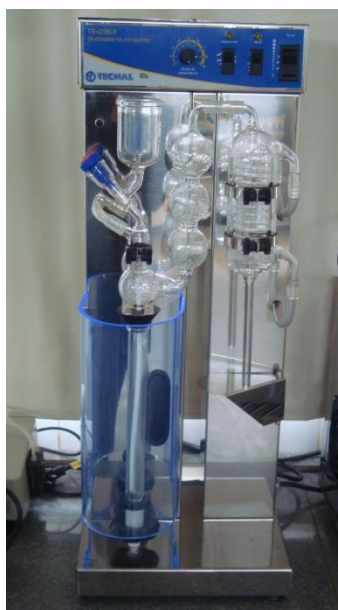
Figura 14 – Destilador de nitrogênio (da marca TECNAL) similar ao utilizado no LGA (Fonte: Universidade Estadual de Mato Grosso do Sul).
