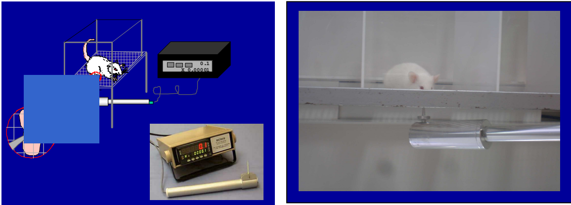
Figura 9 - Aparelho eletrônico Von Frey. Fonte: PESQUISADOR, 2009
