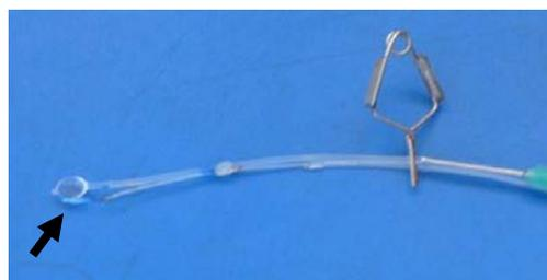
Figura S. Cânula de silicone (Silastic, i.d. 0.58mm, o.d. 0.97mm, Dow Corning) contendo um balão distensível em sua extremidade (seta) utilizada para distensão atrial e acoplada a mesma uma cânula de polietileno (PE10) para registro da pressão venosa central.
