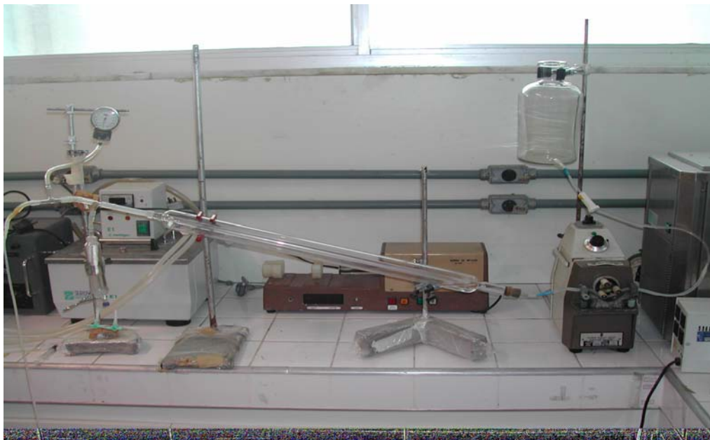
Figura 14: Foto do sistema de perfusão de leito vascular mesentérico (ISCB-UECE).
