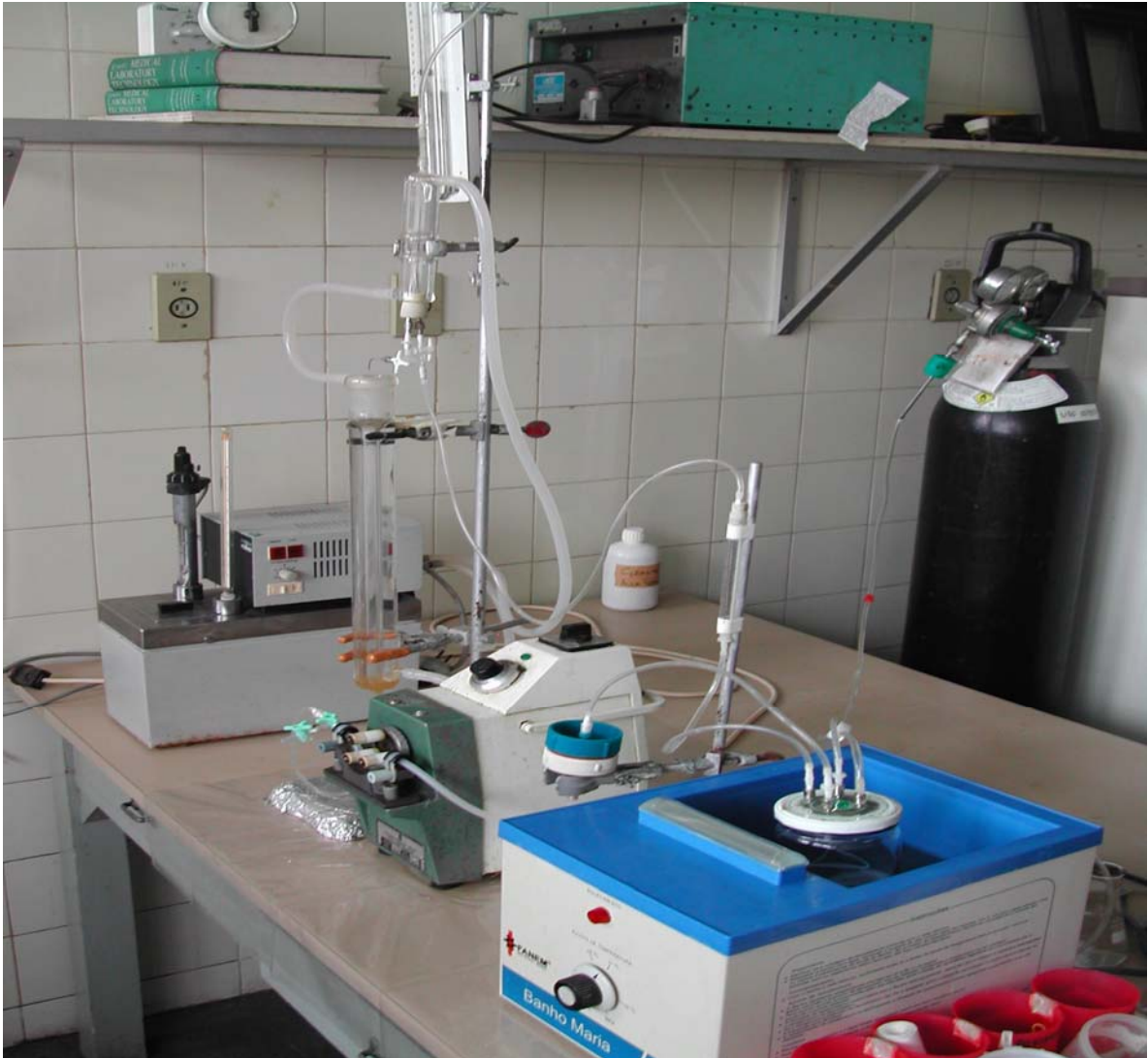
Figura 8: Foto do sistema de perfusão de rim isolado (LAFAVET-UFC)
