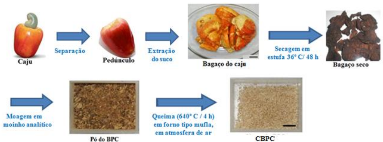
Figura 7. Esquema de preparação das cinzas do pedúnculo do caju (adaptado de SANTOS, 2007).
