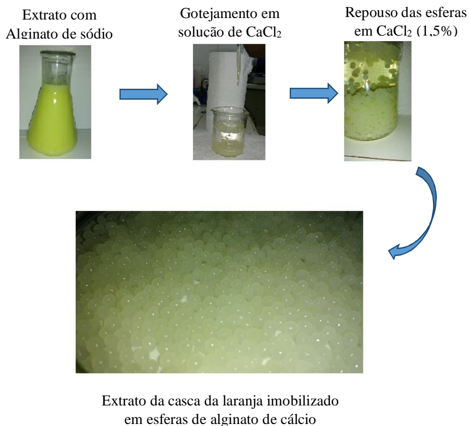
Figura 93- Esferas de alginato de cálcio sendo formadas (esquerda) e esferas após separação da solução (direita).
