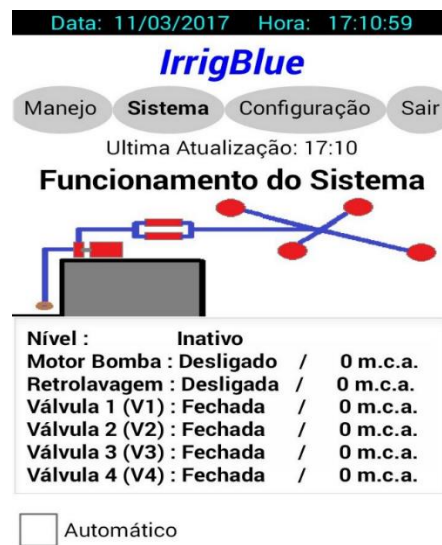
Figura 7: Tela de monitoramento do sistema hidráulico
