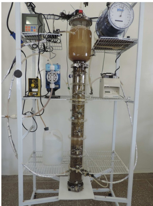
Figura 8 - Reator UASB utilizado para produção de ácido capróico.
