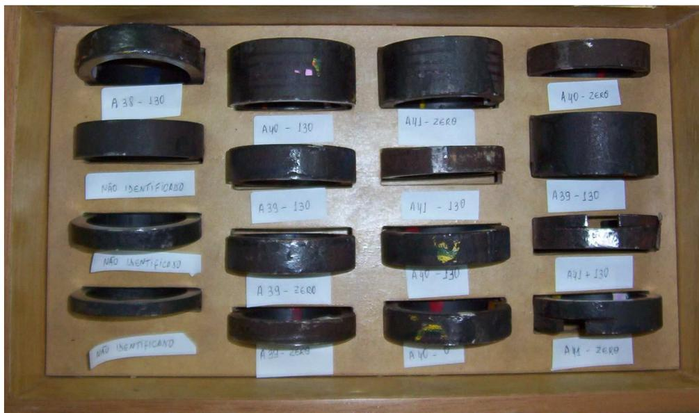
**Figura 3.1:** Corpos de prova inspecionados pelas técnicas magnética e ultrassônica.
