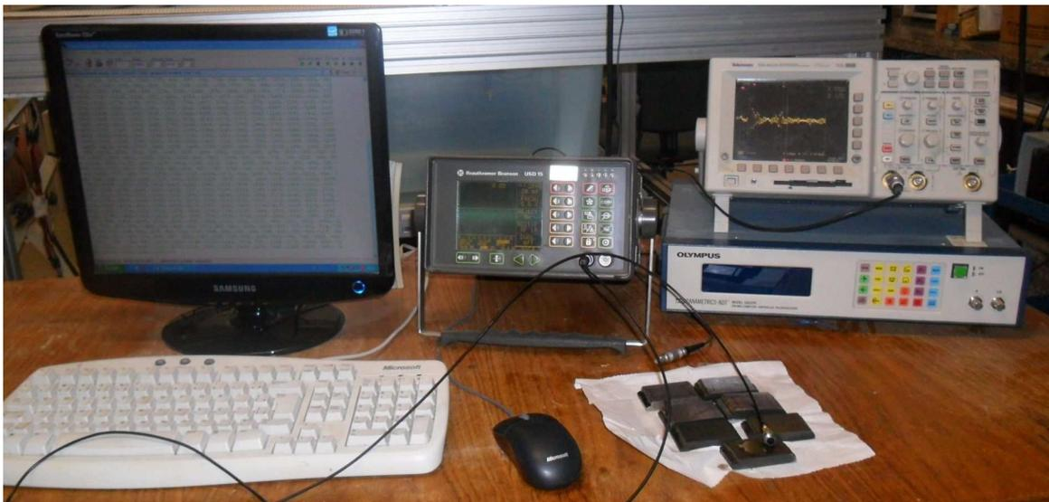
**Figura 3.5:** Sistema de aquisição de dados ultrassônicos.
