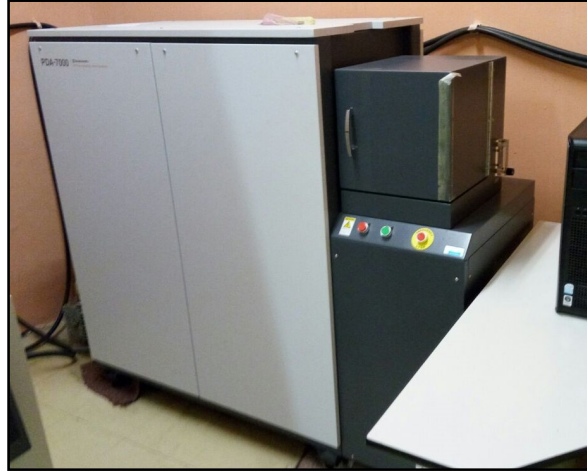
Figura 13 – Espectrômetro de emissão óptica SUIMADZU PDA7000
