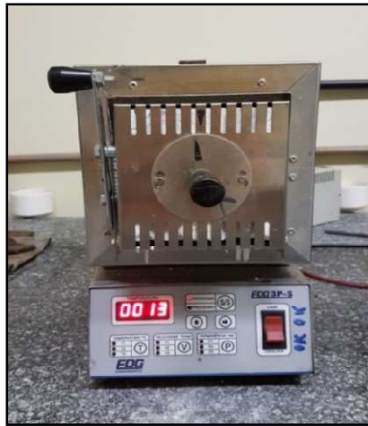
Figura 14 – Forno tipo mufla para tratamentos térmicos
