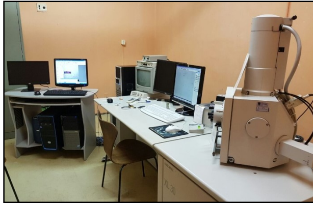
Figura 16 – Microscópio Eletrônico de Varredura Philips XL-30, EBSD OXFORD/HKL Channel 5
