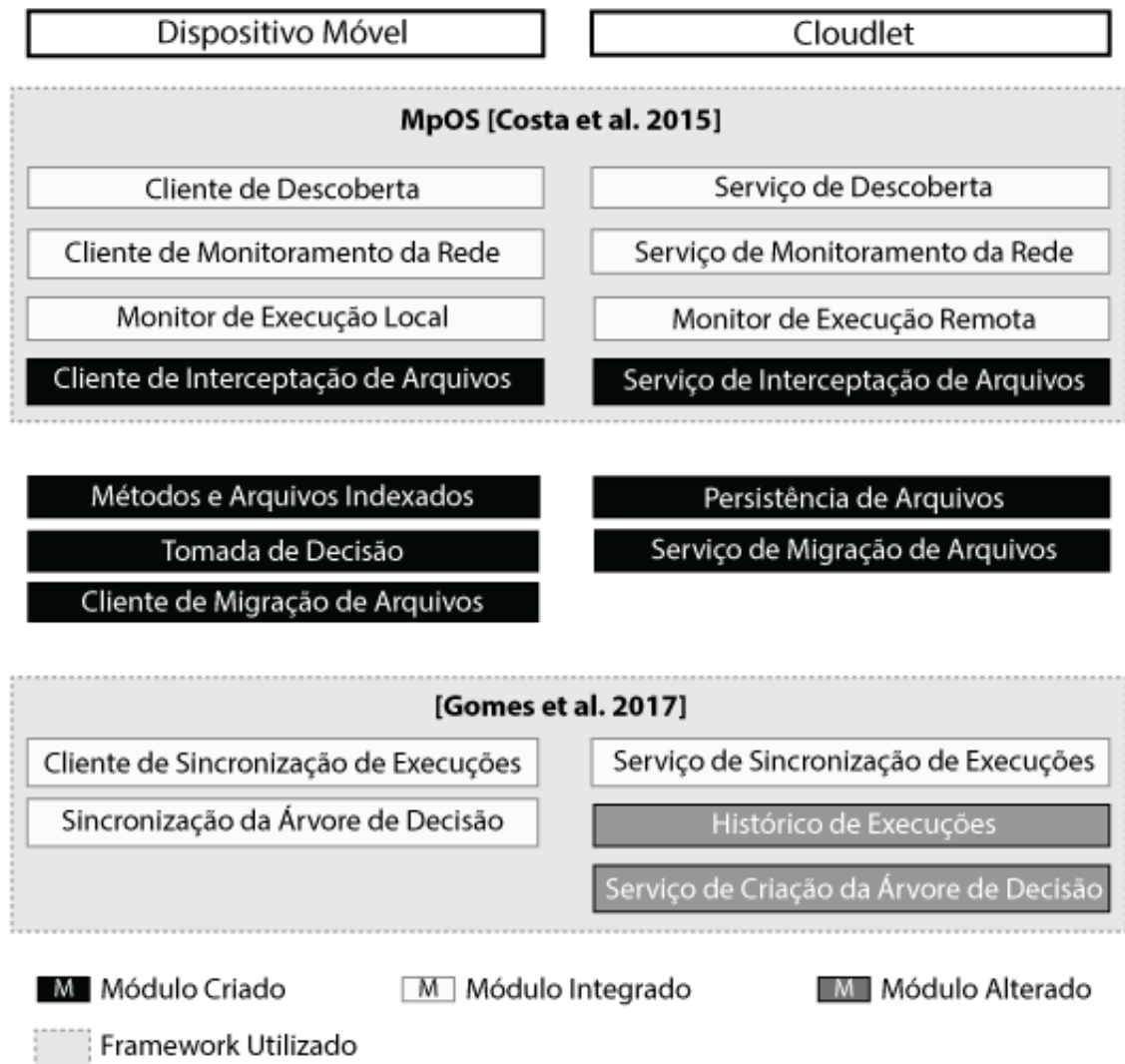
Figura 5 – Arquitetura do mecanismo proposto. Módulos do dispositivo móvel e da cloudlet .
