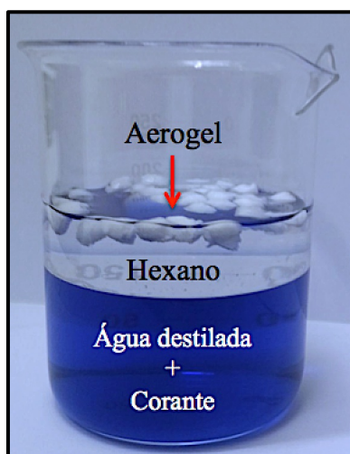
Figura 49 – Flutuabilidade do aerogel AMOG34-2R:8I-30 em sistema hexano/água destilada.
