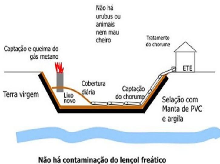
Figura 5 – Modelo esquemático de aterro sanitário.
