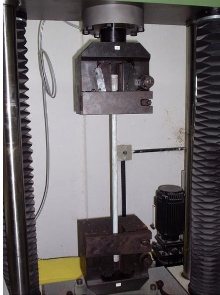
**Figura 4.12.** Ensaio de tração em corpos-de-prova de fibra de vidro (detalhe da Fixação).
