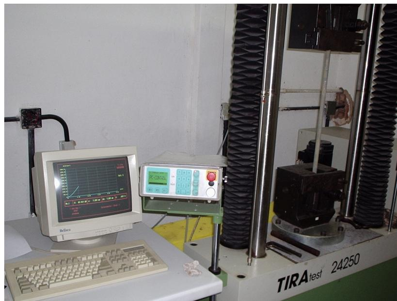
**Figura 4.10.** Ensaio de tração em corpos-de-prova de fibra de vidro.
