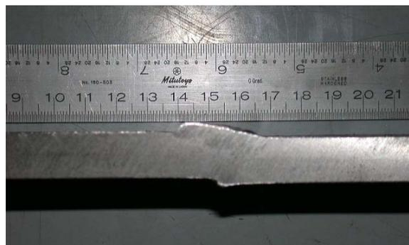
*Figura 2.6. Detalhe do desalinhamento da chapa na junta soldada.*
