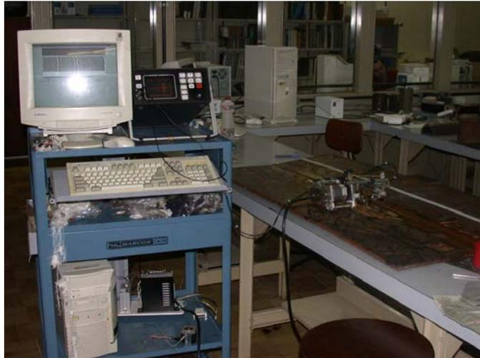
**Figura 2.3.** Inspeção de Ultra-som usando o método TOFD em uma das chapas soldadas com defeito, realizado no LABOEND/COPPE/UFRJ.
