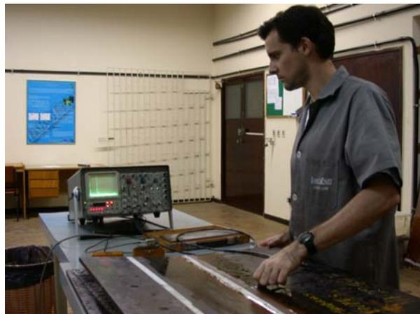
**Figura 2.2.** Ensaio pulso-eco realizado no LABOEND/COPPE/UFRJ em uma chapa soldada com defeitos.
