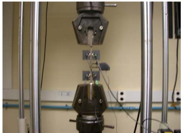
*Figura 2.10. Máquina de Ensaio de Tração Servo-hidráulica com a garra hidráulica e mecânica .*
