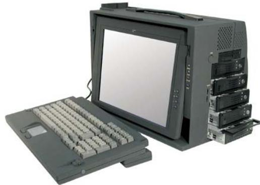
*Figura 2.12. Computador portátil para ensaios em campo.*
