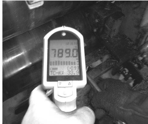
Figura 3.2. Temperatura medida no material a ser laminado
