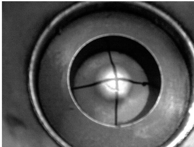
Figura 3.8. Formação da impressão na chapa até início da ruptura
