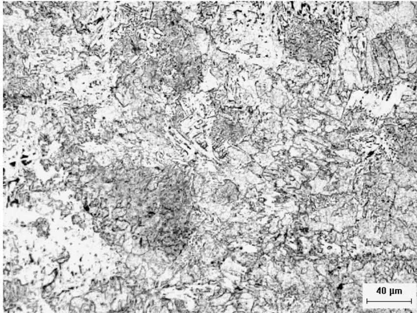
Figura 4.4. Fotomicrografia do aço CE7 (aço baixo-carbono, com 0,147%C p, laminado com temperatura inicial de 700°C) mostrando uma microestrutura de grãos alongados, sendo a maioria grãos ferríticos (regiões claras) e alguns grãos perlíticos (regiões escuras). Ataque: nital 3% (solução química composta com 97% de álcool etílico P.A. + 3% de ácido nítrico)
