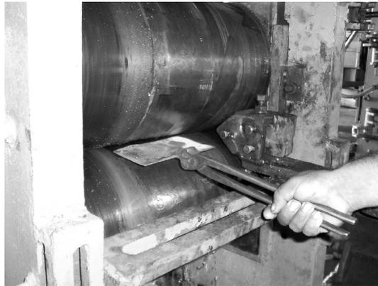
Figura 3.3. Material no início da laminação
