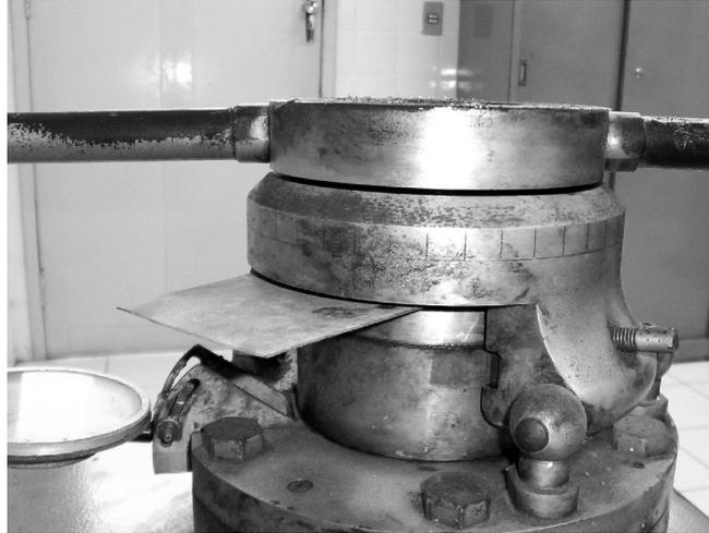
Figura 3.7. Fixação da chapa no equipamento para ensaio de embutimento Erichsen
