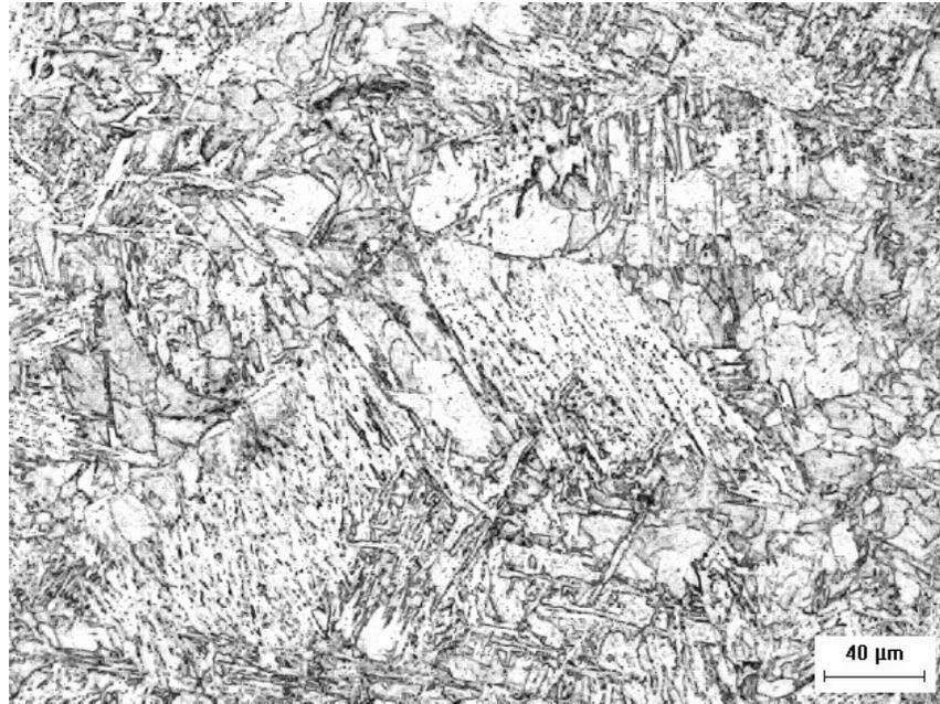
Figura 4.3. Fotomicrografia do aço CE6 (aço baixo-carbono, com 0,147%C p, laminado com temperatura inicial de 600°C) mostrando uma microestrutura de grãos alongados, sendo a maioria grãos ferríticos (regiões claras) e alguns grãos perlíticos (regiões escuras). Ataque: nital 3% (solução química composta com 97% de álcool etílico P.A. + 3% de ácido nítrico)
