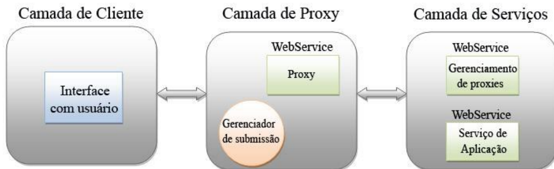
FIGURA 6 – Relacionamento entre o serviço proxy e os demais componentes da arquitetura. Fonte: o autor.
