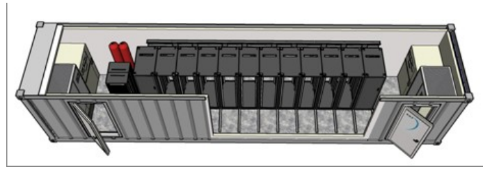
Figura 4: Um modelo de data center baseado em contêineres. (VERDI et al., 2010)
