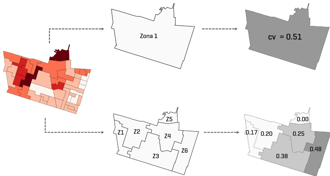
Figura 31 -Passo-a-passo da proposição de nível de agregação de sub-bairro e verificação de homogeneidade.
