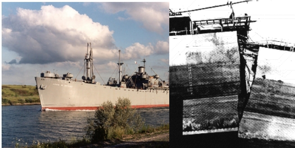
Figura 2.3 - Os navios "Liberty Ships", que durante a segunda guerra mundial, tornaram-se um exemplo de falha por fratura frágil.
