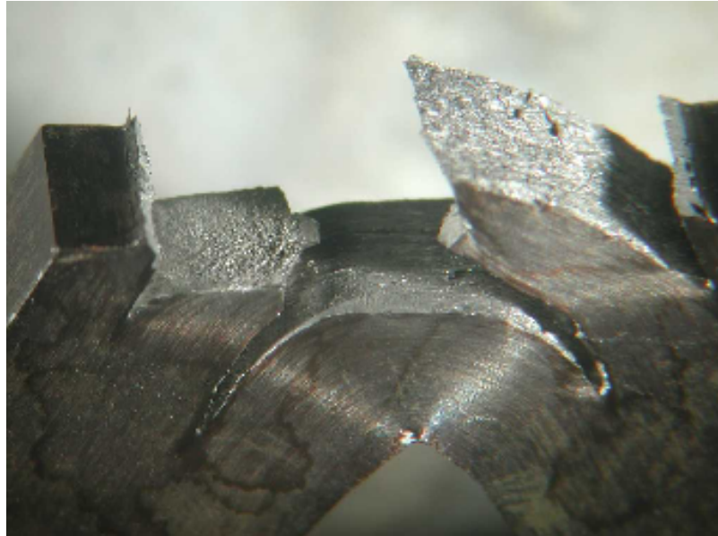
Figura 4.5 - Estrutura obtida nos corpos de provas com dimensões reduzidas, estrutura tipo “arrester”.
