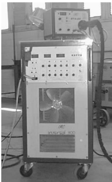
Figura 3.1 – Fonte de energia multiprocesso Inversal 300
