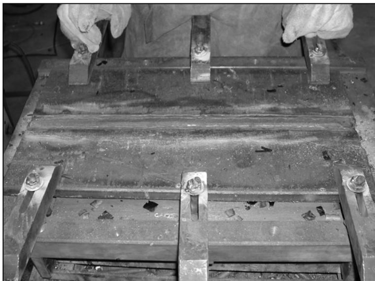
Figura 4.1 – Corpo de prova soldado.
