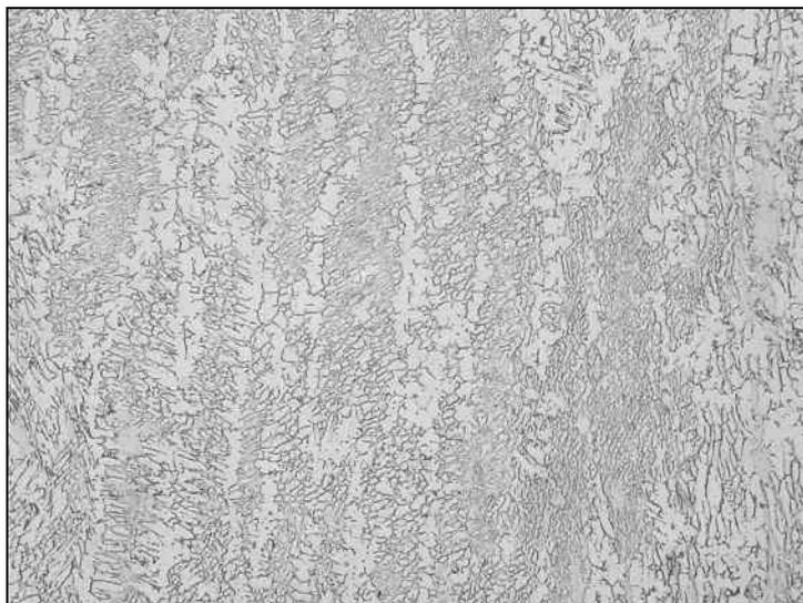
Figura 4.28 – Ferrita  $\delta$  no ensaio F3(309MoL-15). Reagente de Murakami. 200x (Teor: 30,0%).
