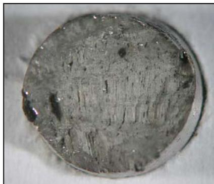
Figura 4.3 – Porosidade na fratura do corpo de prova de tração do ensaio E1.
