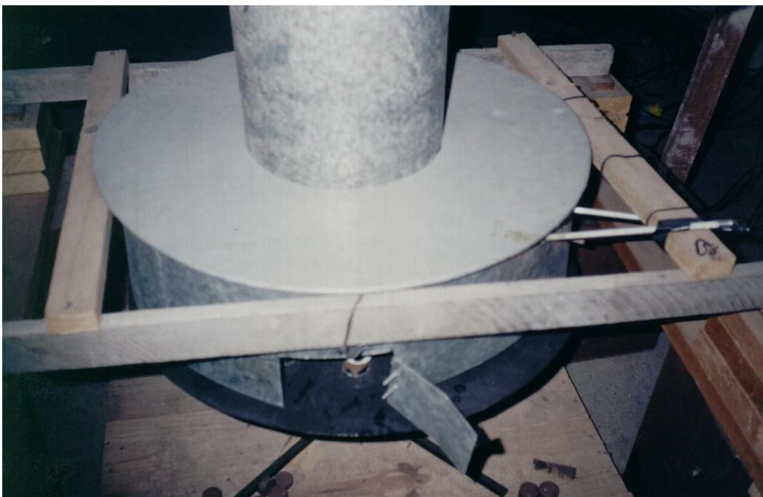
Fig. 9 Foto do secador mostrando a base com os termômetros de bulbo seco e o de bulbo úmido.
