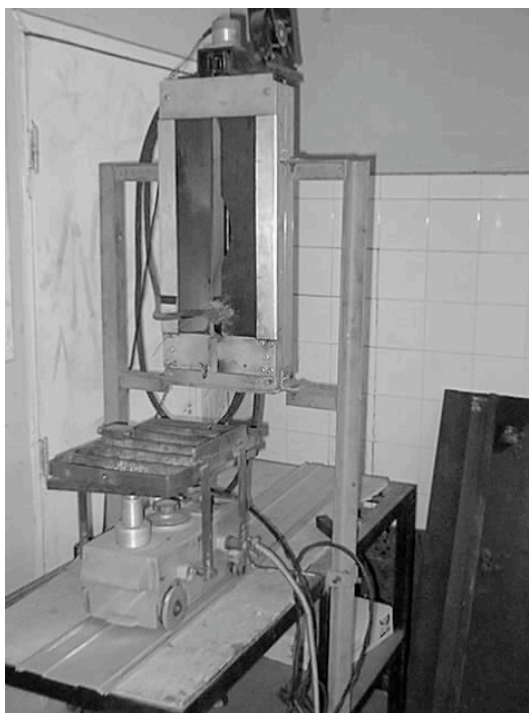
Figura 4.2 – Sistema automáticos de soldagem para pesquisa com eletrodos revestidos
