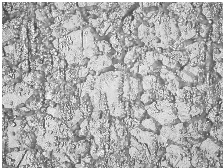
Figura 5.10 – Fotografia do aço AISI 304L submetido a sensitização em forno por 20h à 675 °C (500X).
