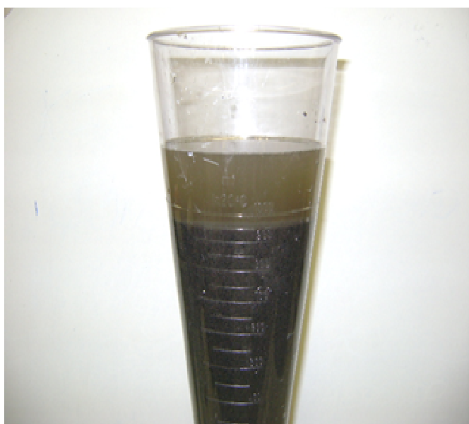
Figura 15 – Inóculo não selecionado de reator UASB mesofílico de uma indústria de cerveja
