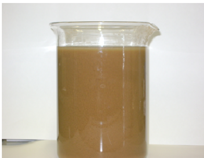
Figura 16 – Inóculo selecionado do reator anaeróbico (desnitrificação) de uma indústria de couro
