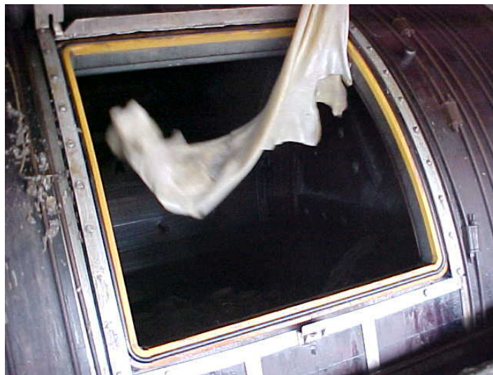
Figura 3 – Pele caleada entrando no fulão de curtimento Fonte: Curtume Maracanaú, (2001).
