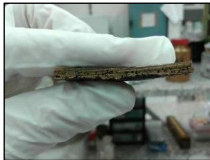
Figura 29 - Compósito ( CpBz-Cd ) com falhas estruturais
