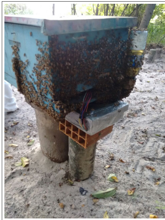
Figura 11 – Nó sensor implantado na colmeia
