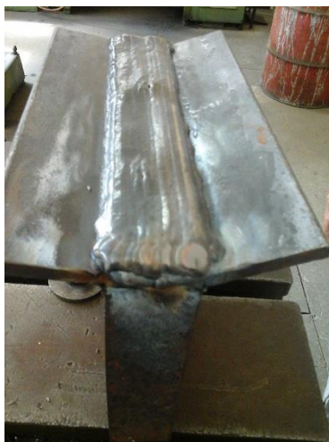
Figura 3.6 - Corpo de prova de aço AISI 8630M amanteigado e usinado
