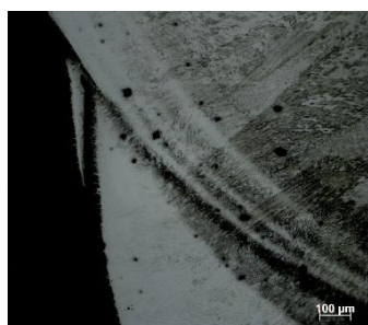
Figura 4.27 – Ilha de metal base na interface dissimilar do metal base AISI 8630M e aço Maraging 250 .
