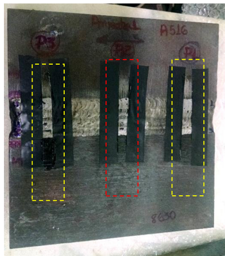
Figura 3.9 – Regiões delimitadas para análise de tensões residuais. A) Junta 04, B) Junta 05.
