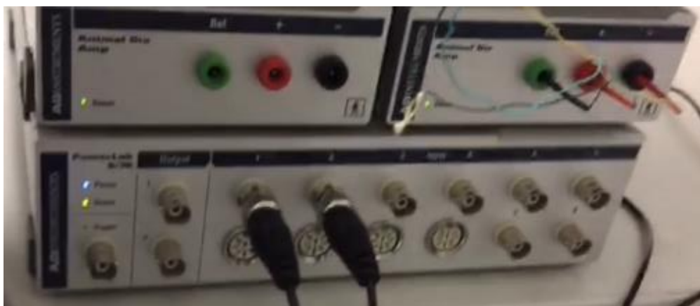
Figura 12: Aparelho da PowerLab ® para captação do EEG. Os ratos foram colocados individualmente na caixa e o cabo de aquisição foi ligado a um micro-conector na cabeça do animal, com os sinais da atividade elétrica capturados por aparelho da PowerLab ® . As gravações do EEG foram analisadas através do programa LabChart 8 Add-ons, versão 8.0. Fonte: figura do próprio autor.
