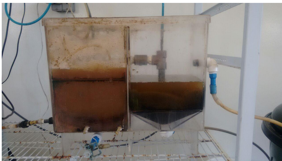
Figura 2- Mini sistema de lodos ativados em escala de bancada, montado no Laboratório de Tecnologia da Biomassa da Embrapa Agroindústria Tropical e usado nesta pesquisa.
