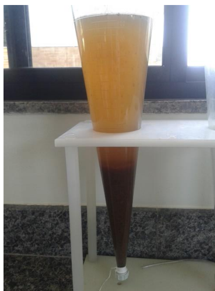
Figura 4- Teste de sólidos sedimentáveis utilizando cone de Imhoff de lodo obtido no sistema de lodos ativados para produção de bioflocos e tratamento de efluentes de carcinicultura.
