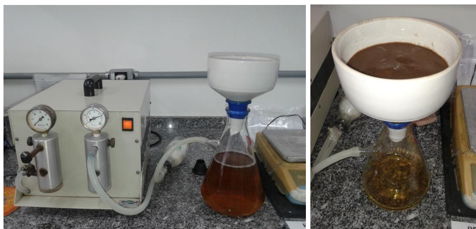
Figura 3-Filtragem com bomba a vácuo de lodo obtido no sistema de lodos ativados para produção de bioflocos e tratamento de efluentes de carcinicultura.
