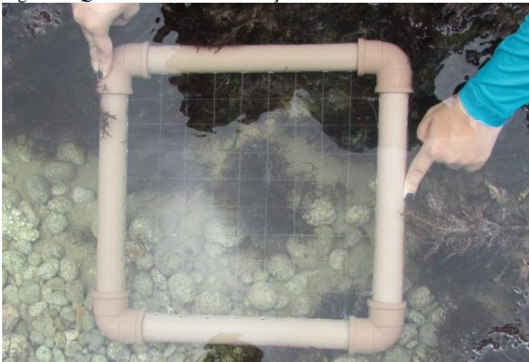
Figura - 6 Quadrat utilizado na aferição do substrato
