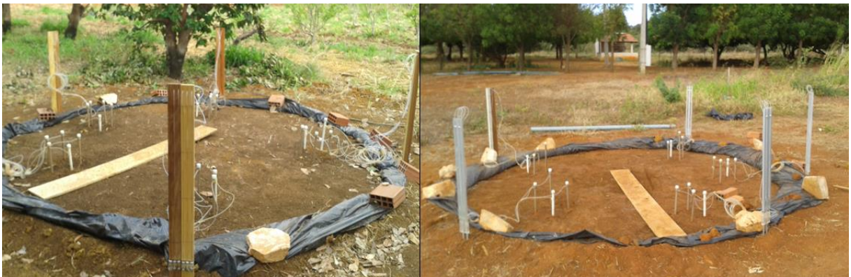
Figura 4 – Disposição dos tensiômetros nos perfis instantâneos.
