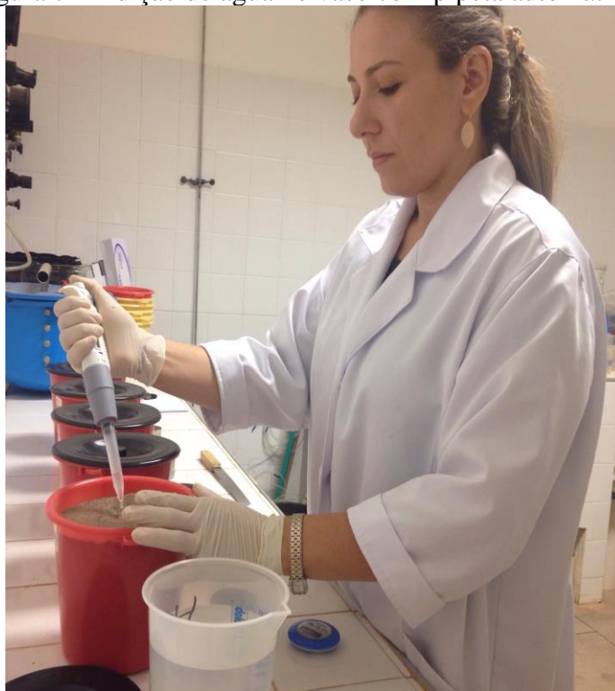
Figura 7 – Adição de água no vaso com pipeta automática.
