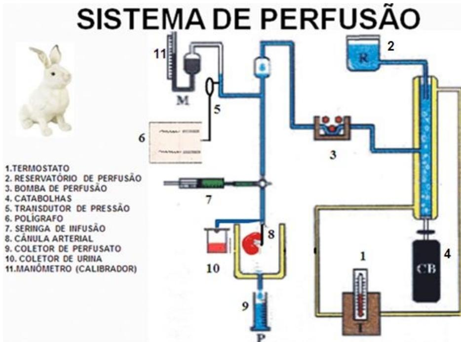
Figura 4. Desenho esquemático do sistema aberto de perfusão de rim de coelho
