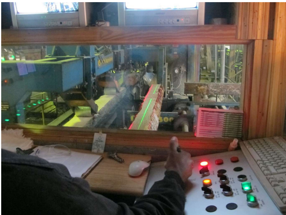
Figura 27 – Tronco de madeira sendo medido a laser para otimizar corte
