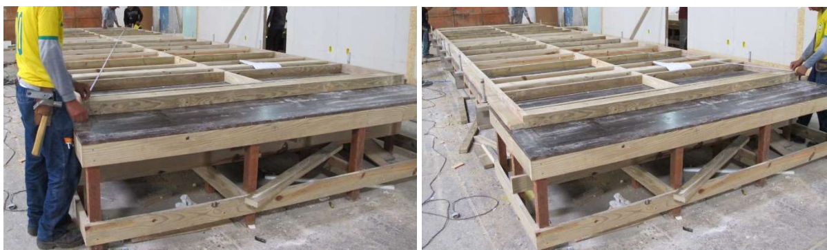
Figura 46 – Medição de diagonais de estrutura comprimida
